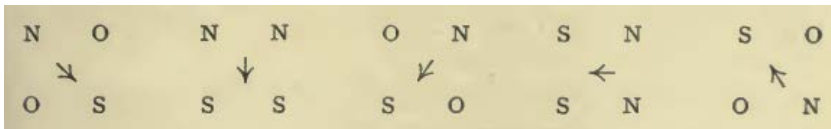
Слика 1.2 Стварање обртног поља Бејлијевим апаратом
