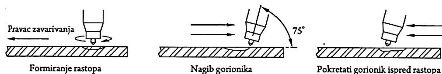
Slika 46: Počinjenje i izvođenje zavarivanja TIG postupkom bez korišćenja dodatnog materijala
